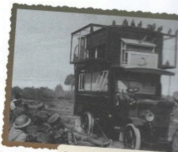
Een auto als verplaatsbare duiventil: de plek waar de duiven steeds weer nsartoe terug zouden vliegen.
